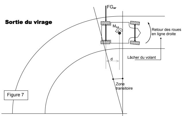
A la sortie du virage le conducteur relâche son action sur le volant, le couple appliqué aux roues autour de l'axe de pivot par le conducteur devient nul. Les roues se retrouvent soumises aux moments d'auto-alignement induits par la dérive des pneumatiques et sont donc ramenées vers une situation de dérive nulle : les efforts de guidage chutent à zéro à l'avant (figure 7).
