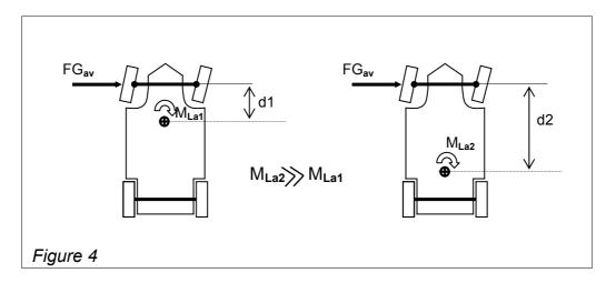
La figure 4 illustre bien le fait qu'un CDG centré arrière améliore grandement le vivacité du véhicule en entrée de virage alors que la configuration habituelle des véhicules modernes (GMP sur l'avant) rend ce véhicule beaucoup plus "paresseux" en entrée de virage. Nous verrons plus loin que la vivacité du véhicule centré AR entraîne d'autres inconvénients sur le comportement dynamique.
