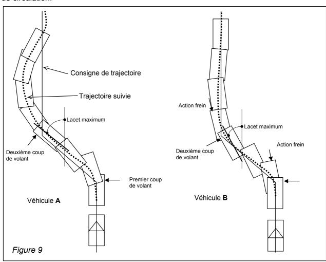
Les schémas de la figure 9 montre la réaction d'un véhicule A à deux coups de volant successifs et assez brutaux puisque ce genre de manœuvre peut être effectuée de manière "réflexe" devant un obstacle imprévu.
