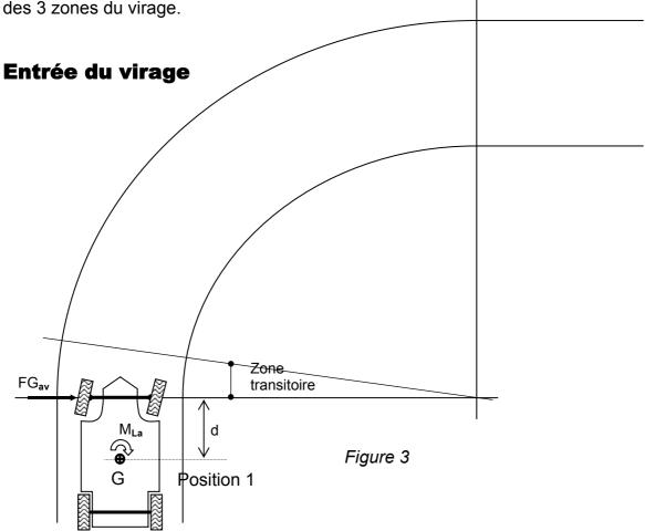
A l'entrée du virage le conducteur agit sur le volant : les roues avant changent d'orientation alors que le véhicule est toujours sur une trajectoire rectiligne. Ceci met les pneumatiques avant en situation de dérive et il produisent des efforts de guidage orientés vers l'intérieur du virage.
