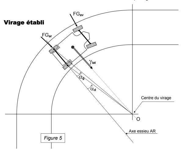
La rotation de lacet a permis d'installer les efforts de guidage AR, le schéma montre bien qu'il faut que l'axe de l'essieu AR soit derrière le centre du virage pour que les pneumatiques AR participent au guidage du véhicule (si O était sur l'axe de l'essieu les valeurs des dérives AR seraient nulles et FG<sub>ar</sub> serait nul ce qui est impossible en virage). La résultante des efforts de guidage appliqués au véhicule produit
