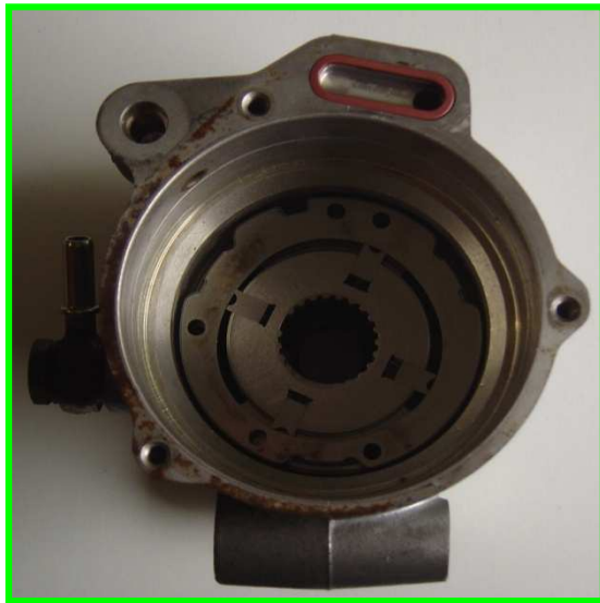
A] Pompe de Transfert
